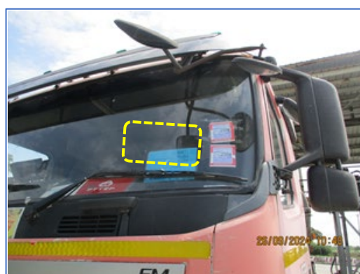
ภาพถ่ายที่ 2-12 รถบรรทุกน้ำมันซึ่งติดตั้งอุปกรณ์ระบุตำแหน่งด้วยดาวเทียม (GPS)
