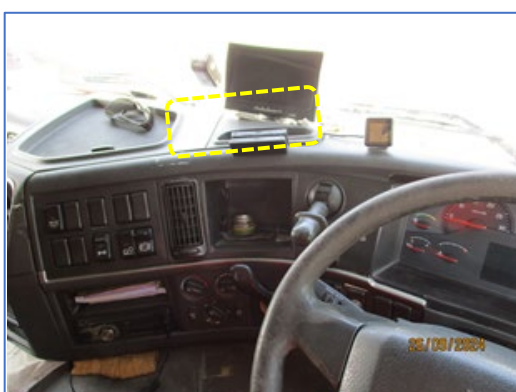
ภาพถ่ายที่ 2-12 รถบรรทุกน้ำมันซึ่งติดตั้งอุปกรณ์ระบุตำแหน่งด้วยดาวเทียม (GPS)
